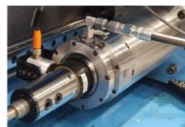
**Maschinenschnittstelle zur Medien-/Signaleinkopplung**
