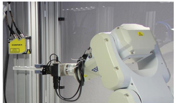
Optisches Scannen des Werkstücks
