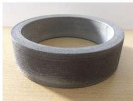
3D-gedruckter Verbundwerkstoff aus Fe<sub>3.5</sub>Si
