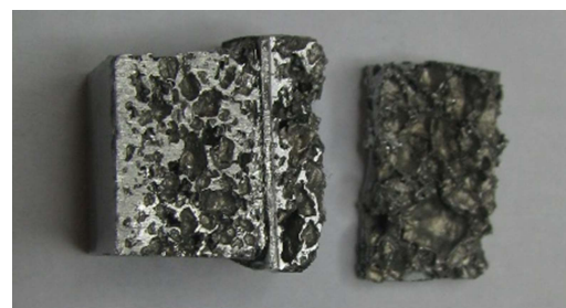
Versteifungswirkung der Fügeflächen
