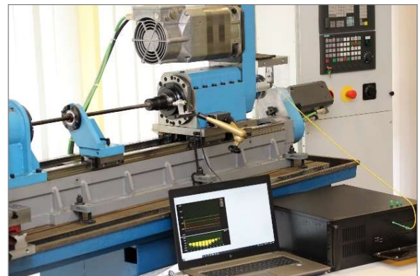
Erprobung des High-Speed-Systems in einer Tiefbohrereinheit
