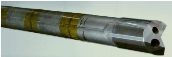
Faser-Bragg-Gitter auf einen Einlippentiefbohrer Ø 16 mm
