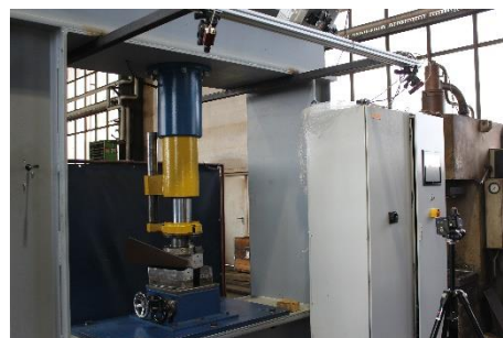
Versuchsstand Umformpresse mit integrierter Messtechnik
