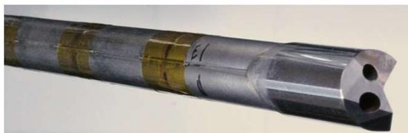
Faser-Bragg-Gitter auf einen Einlippenbohrer Ø 16 mm
