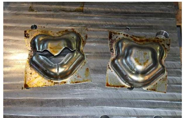
Abmusterung von Demonstratorbauteilen aus hochfesten Aluminiumwerkstoffen
